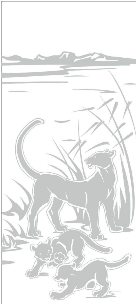
Пантера дверь 2 Пантера 1 (бо), (гм) Рисунок без объема или глубокая матировка. MIN размер рисунка двери 2: 1178*645 мм К=0,55 Серые части рисунка - матовые, белые части рисунка - прозрачные или зеркальные
